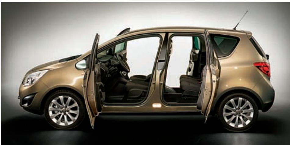
*Garantieren bestmöglichen Zutieg: die FlexDoors® des neuen Opel „Meriva“. Der Zutieg zum Fond erfolgt an der Stelle, wo sich der größtmögliche Platz bietet.*
