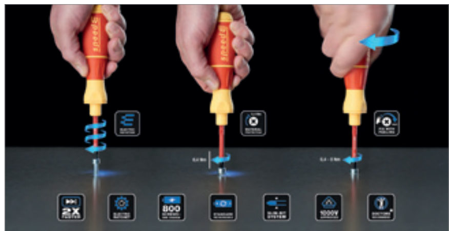
Drei Schritte in einer Bewegung: Erst temporeich elektrisch drehen bis zur Materialschutzfunktion von 0,4 Nm, dann manuell, gefühlvoll mit elektrischer Ratschenfunktion nachjustieren und festziehen.
