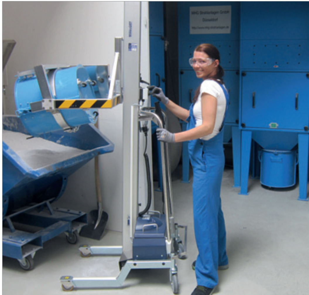
Spezielle Lösungen für Lastaufnahmen mit Niveauregulierung bieten ergonomischen Komfort.
