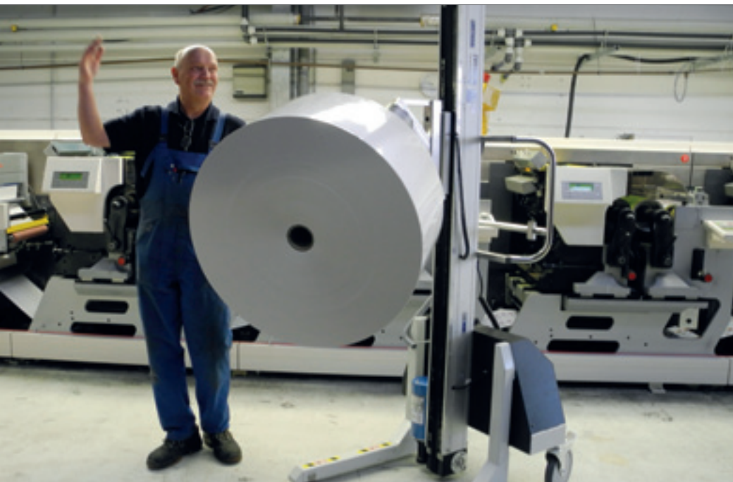
Auch schwere Rollen lassen sich mühelos abschieben. Dafür sorgt der horizontale Dorn des Rollenmanipulators.
