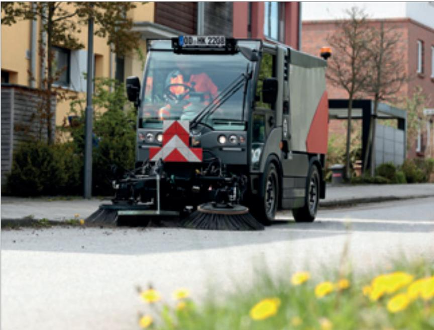
Für den Citymaster 2200 setzte Hako Ergonomie-Standards, wie sie für Lastkraftwagen gelten.
